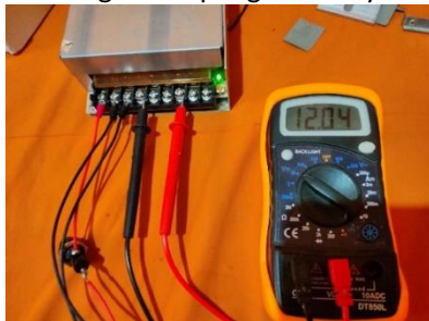
Gambar 9. Pengukuran tegangan pada catu daya eksternal
