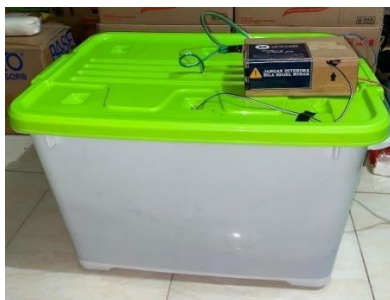
Gambar 12. Realisasi Perangkat Keras Sistem Monitoring Proses Pembuatan Kompos
